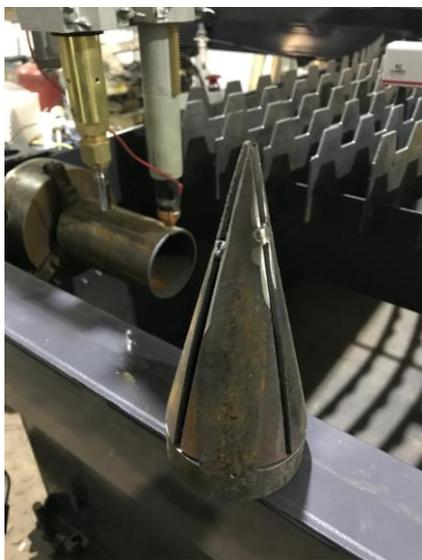
Четвертая дополнительная ось (ось А) для резки круглых труб. Позволяет фигурно, по программе резать трубы диаметром 50-250 мм. Возможность применения: винтовые сваи, фигурные элементы конструкции, элементы соединения трубопроводов и т.д.
