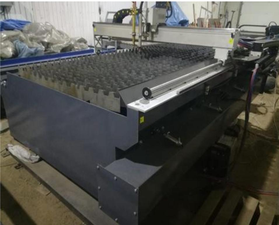
Предназначена для качественного плазменного раскроя листового металла с рабочей зоной 3.1 м x 1.55 м, толщиной листа 1 до 100 мм (зависит от источника резки).
