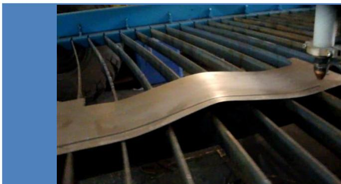
Принцип работы контроля высоты основан на измерении напряжения дуги плазматрона при его работе. В связи с этим нет необходимости в установке на резаке дополнительных неудобных тарелок и внешних навесок.
