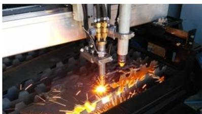
Данную модель возможно дооснастить дополнительным газо-кислородным оборудованием, включающим газовый резак, электронику управления, управляющие клапана, редуктора, огнепреградительные клапаны и т.д..
